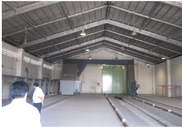
Đầu phát tia x của máy soi Container
